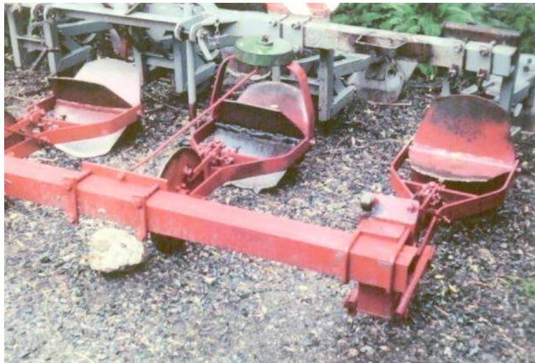
Obr. 3.9.: Detail hrázkovače brambor
