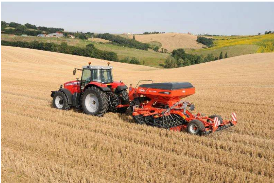
Obr. 3.5.: Výsev kukuřice bezorebným secím strojem do rostlinných zbytků předplodiny (foto: Agrotec)
