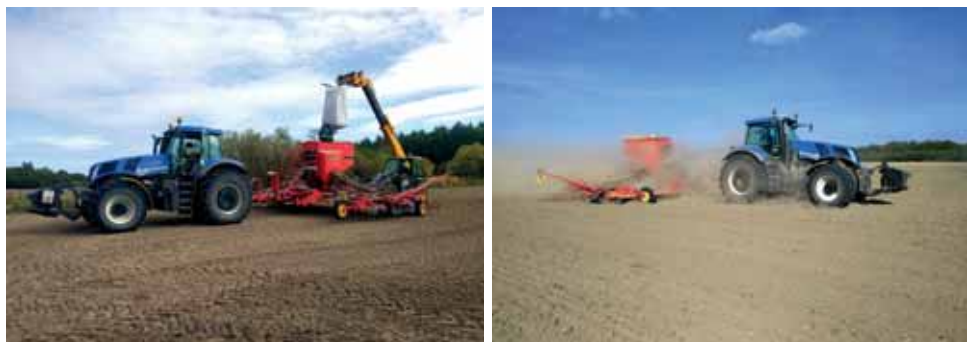
Obr. 5.1.: Secí stroj Väderstad Rapid A800 využívaný v podniku AGRA Řisuty (foto Záborský).
