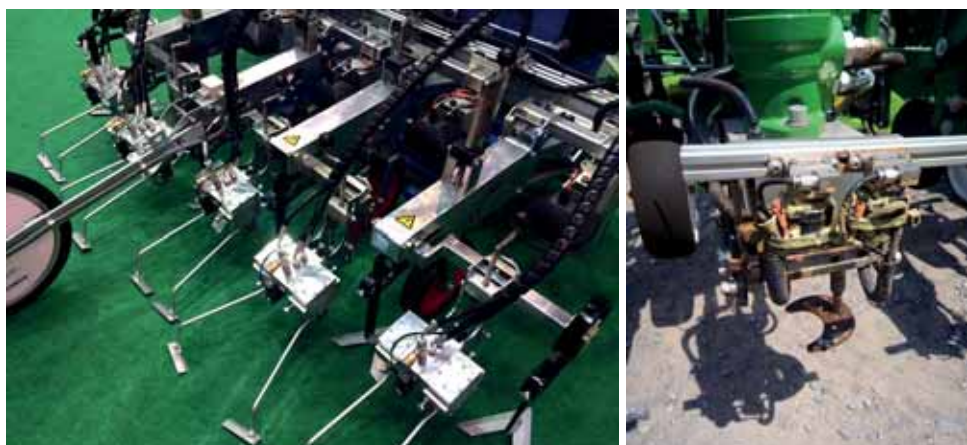
Obr. 101: Detail pracovních nástrojů pleček pro cílenou kultivaci v řádku (foto Kroulík).
