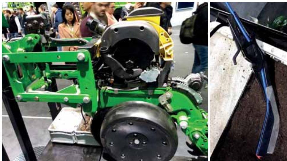
Obr. 73: Výsevní sekce vybavená senzorikou pro měření vlhkosti půdy a systémem pro variabilní hloubku setí firmy Precision Planting (foto Brant).
