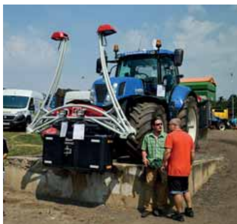
Obr. 247: Souprava traktoru rozmetadla Amazone a traktoru NH T7.260 s nasazeným plodinovým senzorem Isaria (foto Krček).
