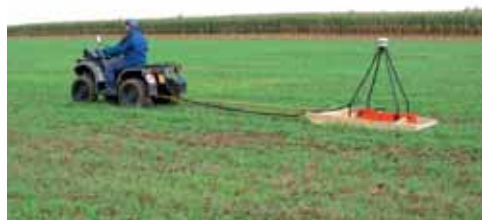
Obr. 29 A, B: Sonda půdní vodivosti EM 38 a měřicí souprava Katedry zemědělských strojů (foto Kroulík).
