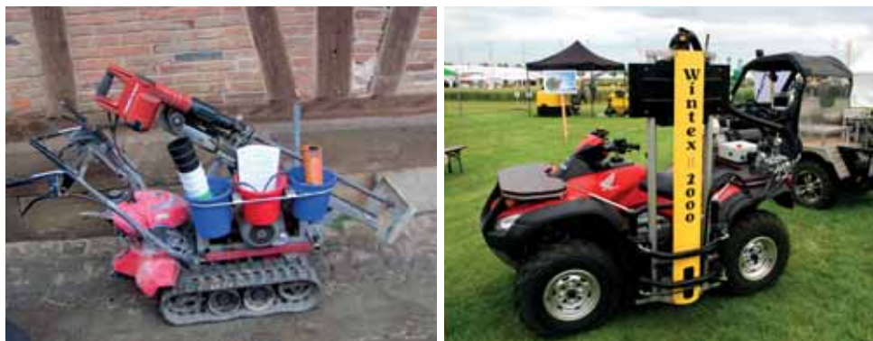
Obr. 77: Poloautomatické a automatické systémy odběru půdních vzorků vykazují vyšší výkon než ruční odběry (foto Brant a Kroulík).
