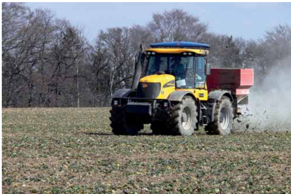
Obr. 240: Souprava JCB Fastrac a rozmetadla Rauch s 1. generací Yara N-senzor (foto Krček).
