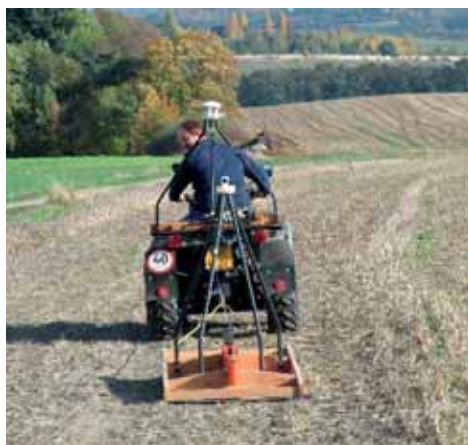
Obr. 1.1.: Měření vodivosti půdy sondou EM 38 provedené 1. 11. 2016 (foto Brant).
