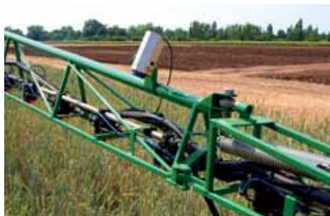
Obr. 118: Ultrazvukový snímač sloužící ke kontrole nastavení výšky aplikačního rámu (foto Kroulík).
