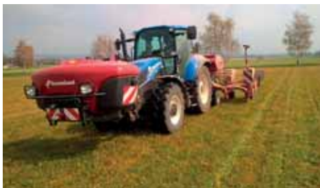
Obr. 94: Cílená pásová aplikace herbicidu na řádek vyseté plodiny při výsevu (foto Šmöger).
