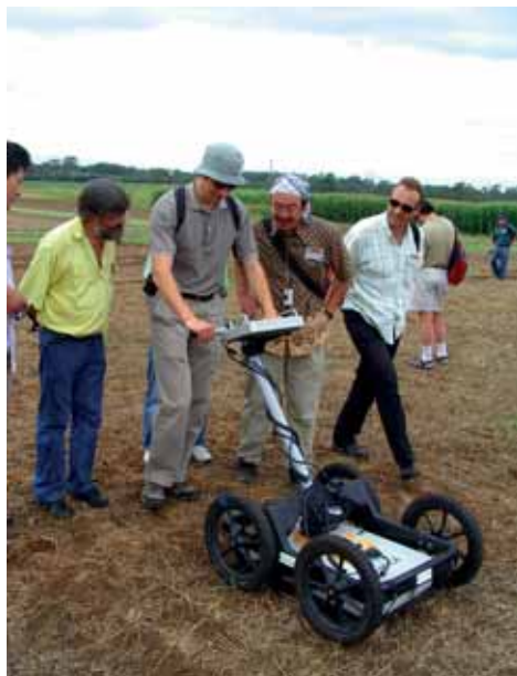
Obr. 52: Ukázka práce s půdním radarem. Výrobce MALÅ Švédsko (foto Kroulík).
