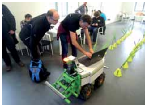
Obr. 97: Platforma Oz určená pro práci v omezených prostorách a menších výměřích. Snímek byl pořízen během soutěžního klání (foto Kroulík).
