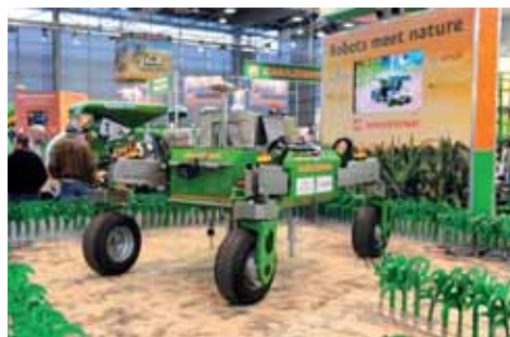
Obr. 174: Polní robot BoniRob osazený soupravou pro fenotypování porostu (foto Kroulík).
