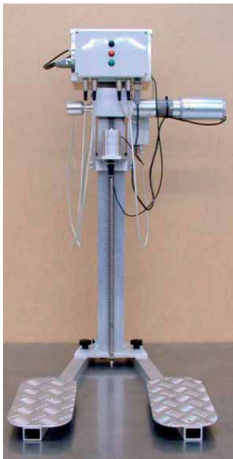
Obr. 34: Poloautomatický penetrometr (zdroj: Yurui a kol., 2008).
