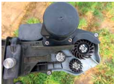
Obr. 153: Semenovod sečí botky s rychloběžným dopravníkem pro transport osiva (foto Kroulík).
