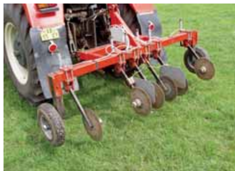
Obr. 31: Zařízení pro měření vodivosti půdy sestavené na Katedře využití strojů, TF, ČZU v Praze (foto Kroulík).
