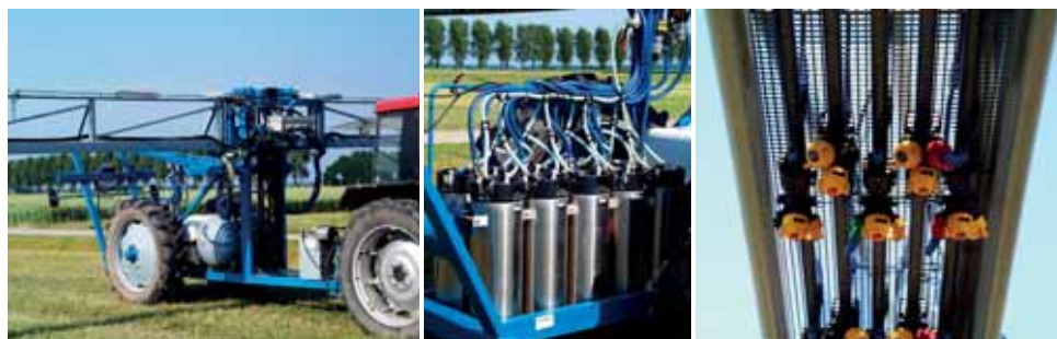
Obr. 91: Ověřovány jsou systémy umožňující cílenou aplikaci rozdílných účinných látek (foto Brant).
