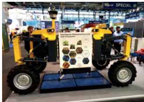
Obr. 95: Rozdílné robotické platformy využívají systém pohybu v kolejových stopách tvořící hranice mezi obhospodařovanými plochami (foto Brant).
