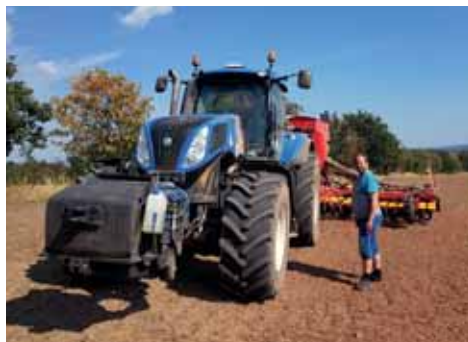
Obr. 248: Agregace traktoru NH T 8.390 se sečkou Väderstad Rapid A800 (foto Krček).
