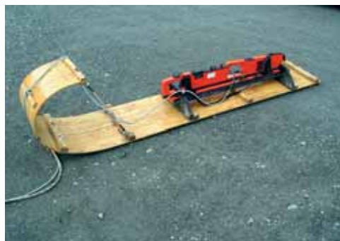
Obr. 29 A, B: Sonda půdní vodivosti EM 38 a měřicí souprava Katedry zemědělských strojů (foto Kroulík).
