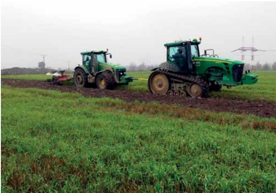
Obr. 45: Měřicí souprava při měření tahové síly (foto Kroulík).
