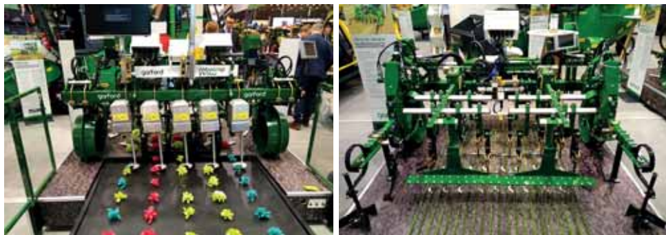
Obr. 100: Robotické plečky představují současný trend v mechanické regulaci plevelů v systémech precizního zemědělství (foto Brant).
