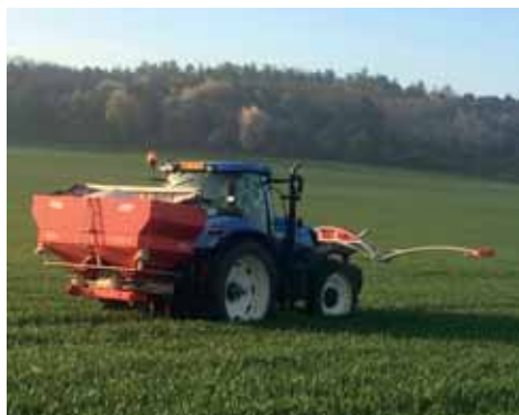
Obr. 199: Souprava osazená systémem ISARIA (foto Kroulík).
