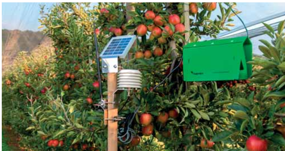
Obr. 136: Automatizovaný feromonový lapač TrapView integrovatelný do IoT (zdroj: http://trapview.blogspot.com/2016/12/modelling-of-up-to-three-different.html ).
