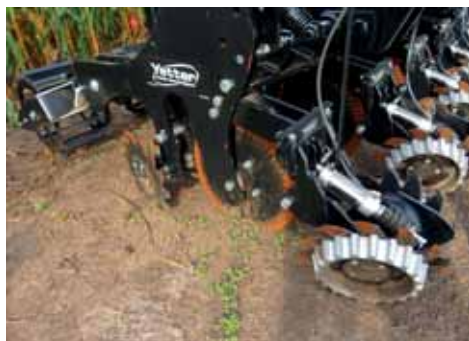
Obr. 155: Technické řešení pro změnu přitlaku na kotouče pro odkliz rostlinných zbytků (foto Kroulík).
