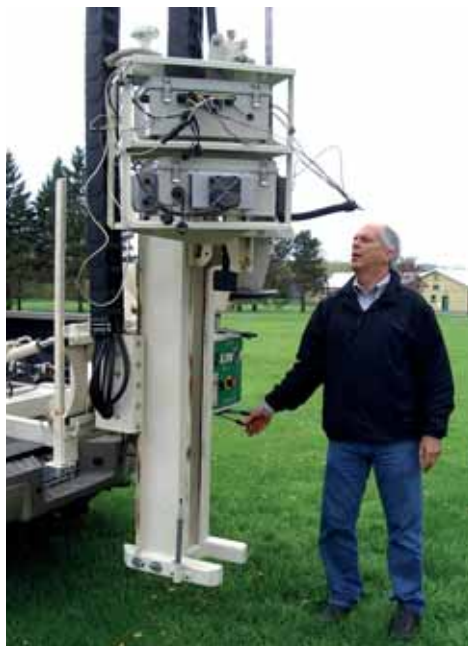
Obr. 35: Poloautomatický penetrometr společnosti Veris (foto Kroulík).
