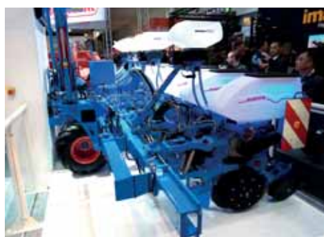
Obr. 142: Systém umožňující variabilní změnu rozteče řádků sečívá stroje u širokořádkových kultur (foto Brant).
