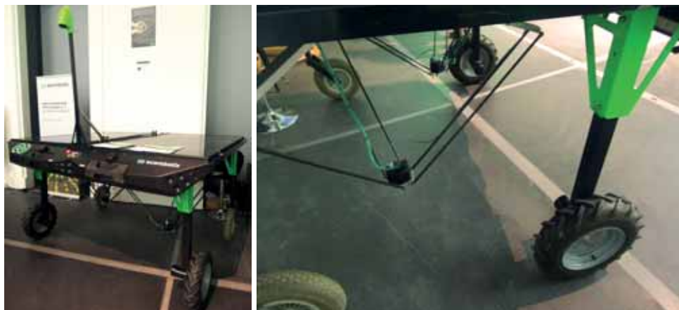
Obr. 103: Robotická platforma Ecorobotix a detail ramene s aplikační hlavou (foto Kroulík).
