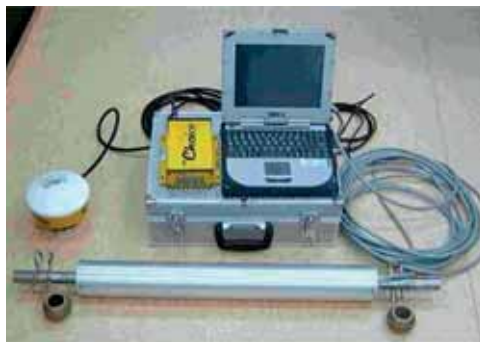
Obr. 48: Gama-spektrometr společnosti The Soil Company - The Mole systém (Zdroj: The Soil Company).
