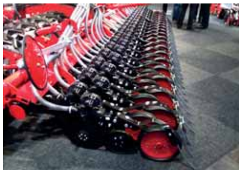
Obr. 141: Systém přesného setí obilnin a řepky firmy Horsch (vlevo) a na počet jedinců (vlevo), foto Brant.
