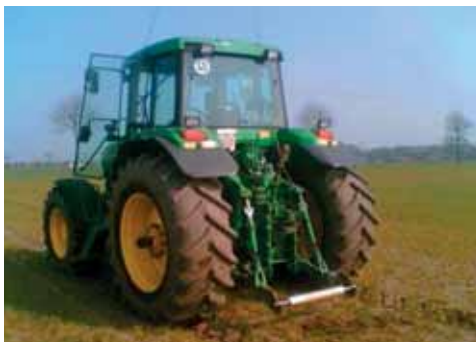
Obr. 48: Gama-spektrometr společnosti The Soil Company - The Mole systém (Zdroj: The Soil Company).
