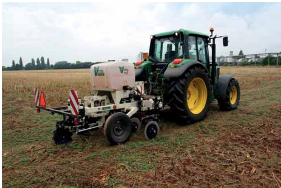
Obr. 78: Monitoring půdního prostředí pomocí mobilní senzorové platformy VERIS (foto Kroulík).
