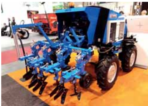
Obr. 95: Rozdílné robotické platformy využívají systém pohybu v kolejových stopách tvořící hranice mezi obhospodařovanými plochami (foto Brant).
