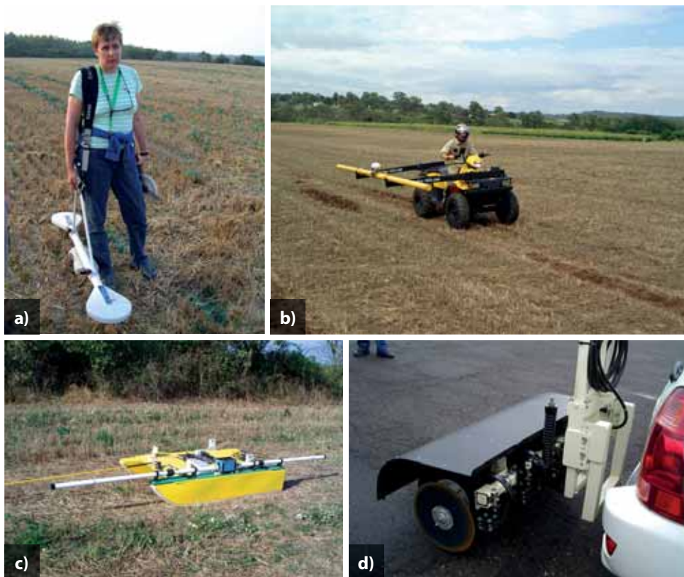
Obr. 32: Konstrukční provedení dalších senzorů pro měření vodivosti půdy: a) Profiler EMP-400, výrobce Geophysical Survey Systems, Inc.; b) DUALEM-4, výrobce AlphaGeosciencePty. Limited; c) EM31-MK2 Geonics Limited; d) Zařízení pro kontaktní způsob měření, výrobce Veris Technologies (foto Kroulík).
