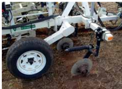
Obr. 30: Systém pro mapování vodivosti půdy Veris 3150 (foto Kroulík).
