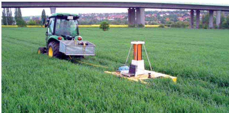
Obr. 49: Spektrometr tažený na saních, který provozuje Helmholtz-Zentrum für Umweltforschung, Umweltforschungszentrum Leipzig-Halle GmbH, Germany (foto Kroulík).
