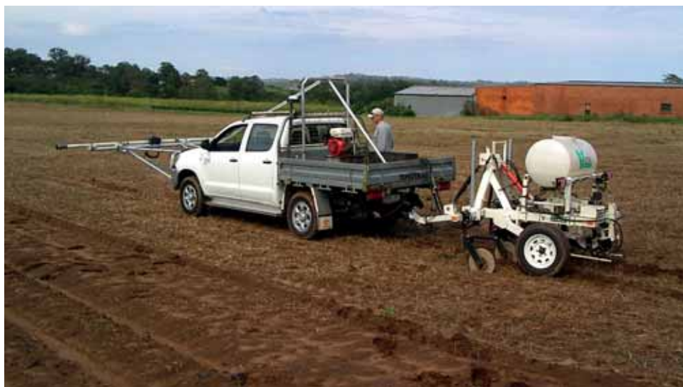
Obr. 59: Měřicí platforma pro stanovování elektrické vodivosti půdy (EC) a pH půdy. Výrobce Veris (foto Kroulík).
