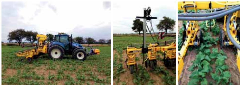
Obr. 93: Pásová aplikace herbicidu na dvojrádek rostlin ozimé řepky se současnou meziřádkovou kultivací meziřádku s využitím optické navigace plečky (foto Brant).
