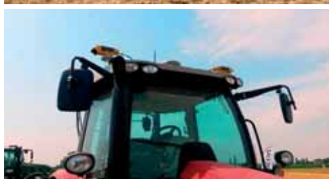
Obr. 177: Příklady technického řešení optických senzorů a jejich zavěšení nebo montáž na stroji (shora): Yara N-senzor, Fritzmeier/Claas ISARIA, AgLeaderOptRx, TrimbleGreenSeeker, TopconCropSpec (foto Kroulík).
