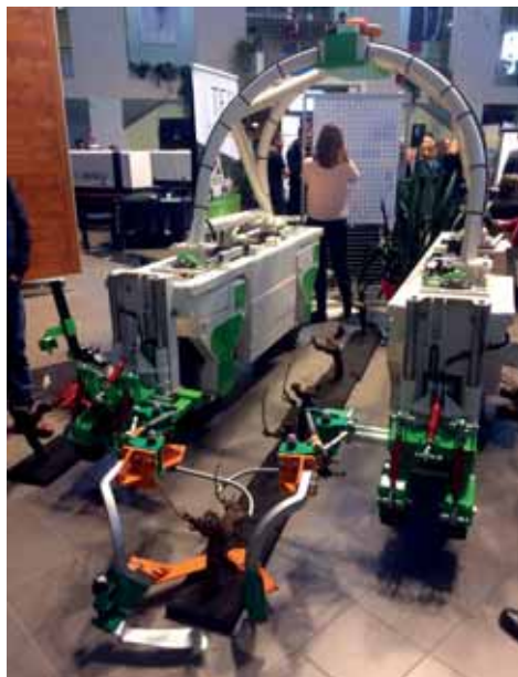
Obr. 98: Platforma TED určená pro práci ve vinicích (foto Kroulík).
