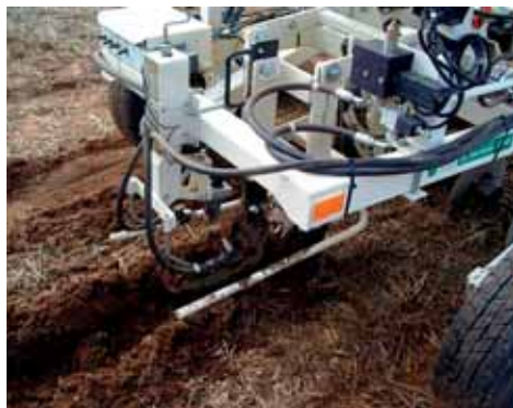
Obr. 56: Kombinace senzorů pro měření půdní vodivosti kontaktní metodou a pH (foto Kroulík).
