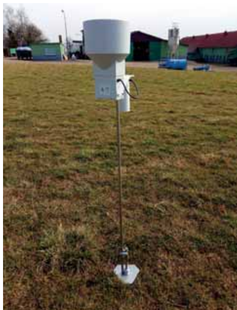
Obr. 3.1.: Podpůrná meteorologická stanice RainSet 2 na pozemcích společnosti AGRA Řisuty (foto Brant).
