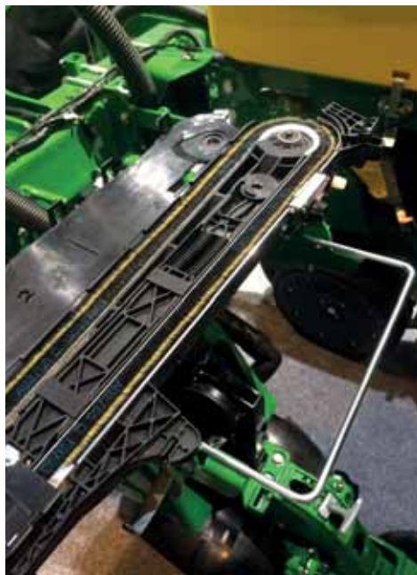
Obr. 154: Kartáčový dopravník sečí botky (foto Kroulík).
