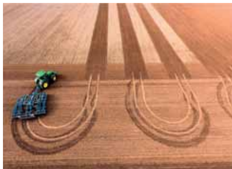
Obr. 221: Autonomní navádění a otáčení na souvratích, společně s autonomním ovládáním nářadí je prvotním krokem k vyšší autonomii (zdroj: Strom Praha a.s)
