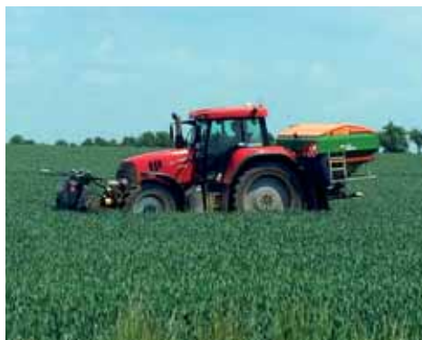
Obr. 178: Traktor Case v agregaci s rozmetadlem Amazone během přihnojování porostu pšenice ozimé. Senzory OptRx jsou nesený na předním závěsu (foto Kroulík).
