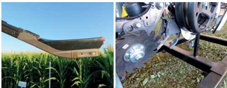
Obr. 61: Detail senzoru SmartFirmer a jeho umístění na secí botce (foto Kroulík).
