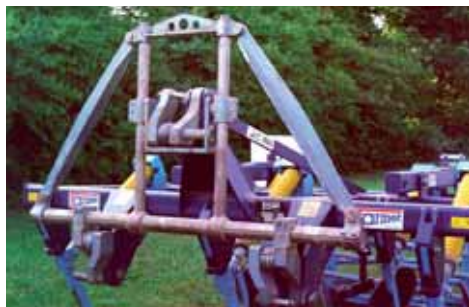
Obr. 39: měřicí rám, vkládaný mezi traktor a měřený stroj (foto Kroulík).
