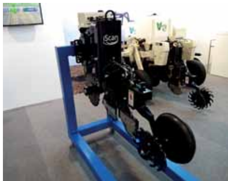
Obr. 57: Kombinovaný senzor Veris iScan (foto Brant).
