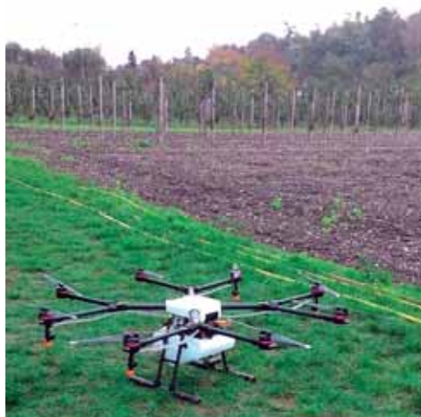
Obr. 129: Bezpilotní prostředek AGRAS vybavený aplikačním zařízením (foto Kroulík).
